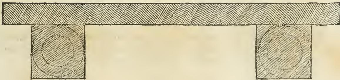
Ma quelle che vsciranno fuor' del muro per la larghezza della basa & il quarto piu, è di necessita che habbino nel muro il lor pilastro quadro di basso rilieuo che gli corrisponda, nel modo di tutto rilieuo non si distendera l'architraue per il lungo del muro ma partendosi in isquadra dal pilastro, andra risaltando a trouare la testa della colonna; & il fregio & la cornice, che adornano l'architraue faranno ancora il simile.
