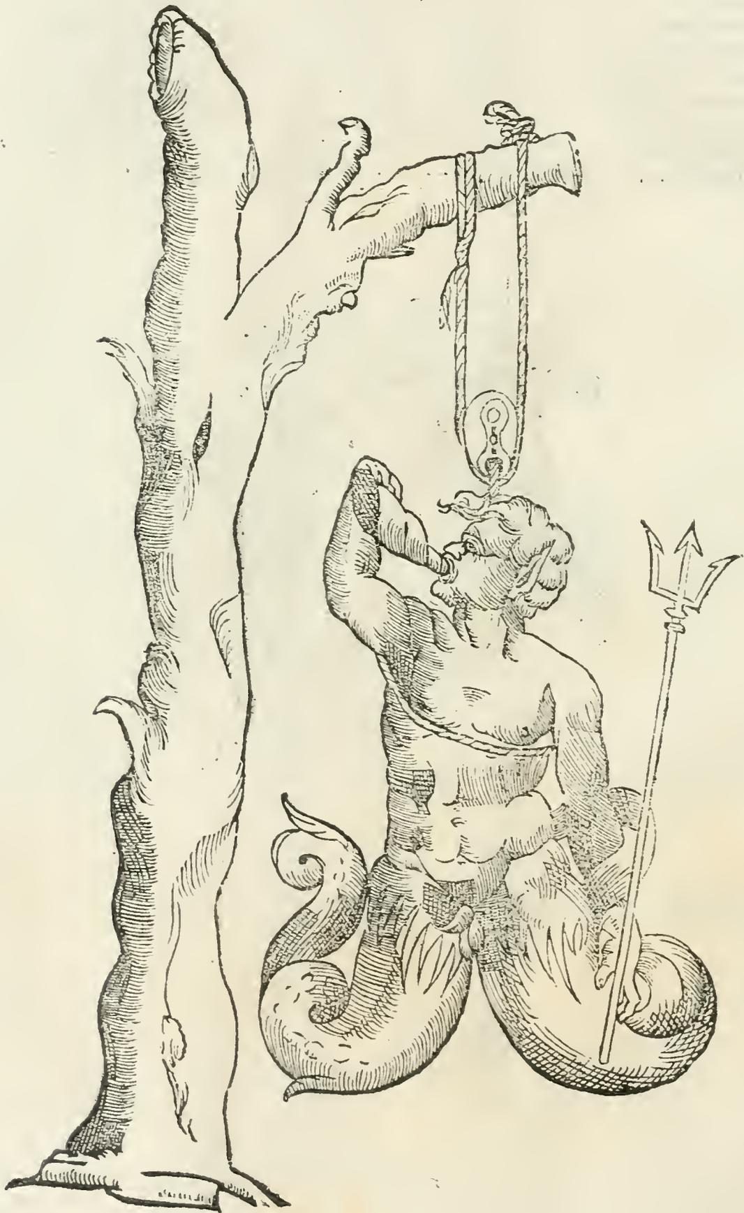
Andiamo piu auanti, aggiugni anchora al Troncane vn'altra taglia, & metti anchora in essa detta fune. Io vò sapere da te quanta fara la portione del peso, che quella parte della fune tirata in alto, & poi messa nella Taglia sofferra cinquecento dirai. Non ti accorgi tu adunque che a questa seconda taglia non si puo dare maggior peso da essa fune, che ella si habbia, & ella ne ha cinquecento non ne parleremo piu adunque.
